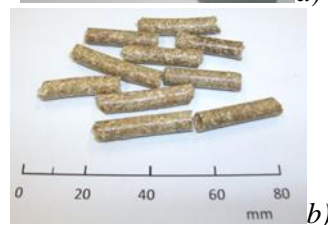
Dugattyús prés (a) és síkmatricás pelletáló(b) termékei
